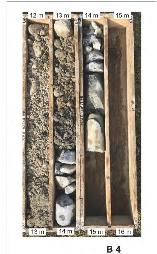
Bohrgutaufnahme Bohrung B 4 (S. 3) Ramm-/Rotationskernbohrung / Endteufe -14,70 m Bohrzeitraum: 22.01.-31.01.2018
