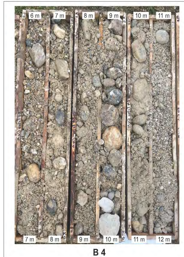
Bohrgutaufnahme Bohrung B 4 (S. 2) Ramm-/Rotationskernbohrung / Endteufe -14,70 m Bohrzeitraum: 22.01.-31.01.2018
