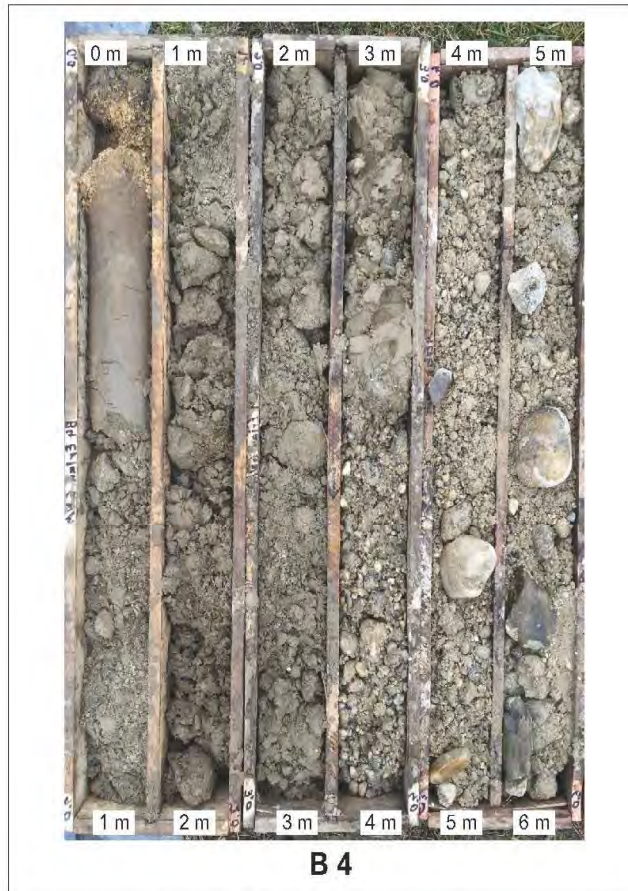
Bohrgutaufnahme Bohrung B 4 (S. 1) Ramm-/Rotationskernbohrung / Endteufe -14,70 m Bohrzeitraum: 22.01.-31.01.2018
