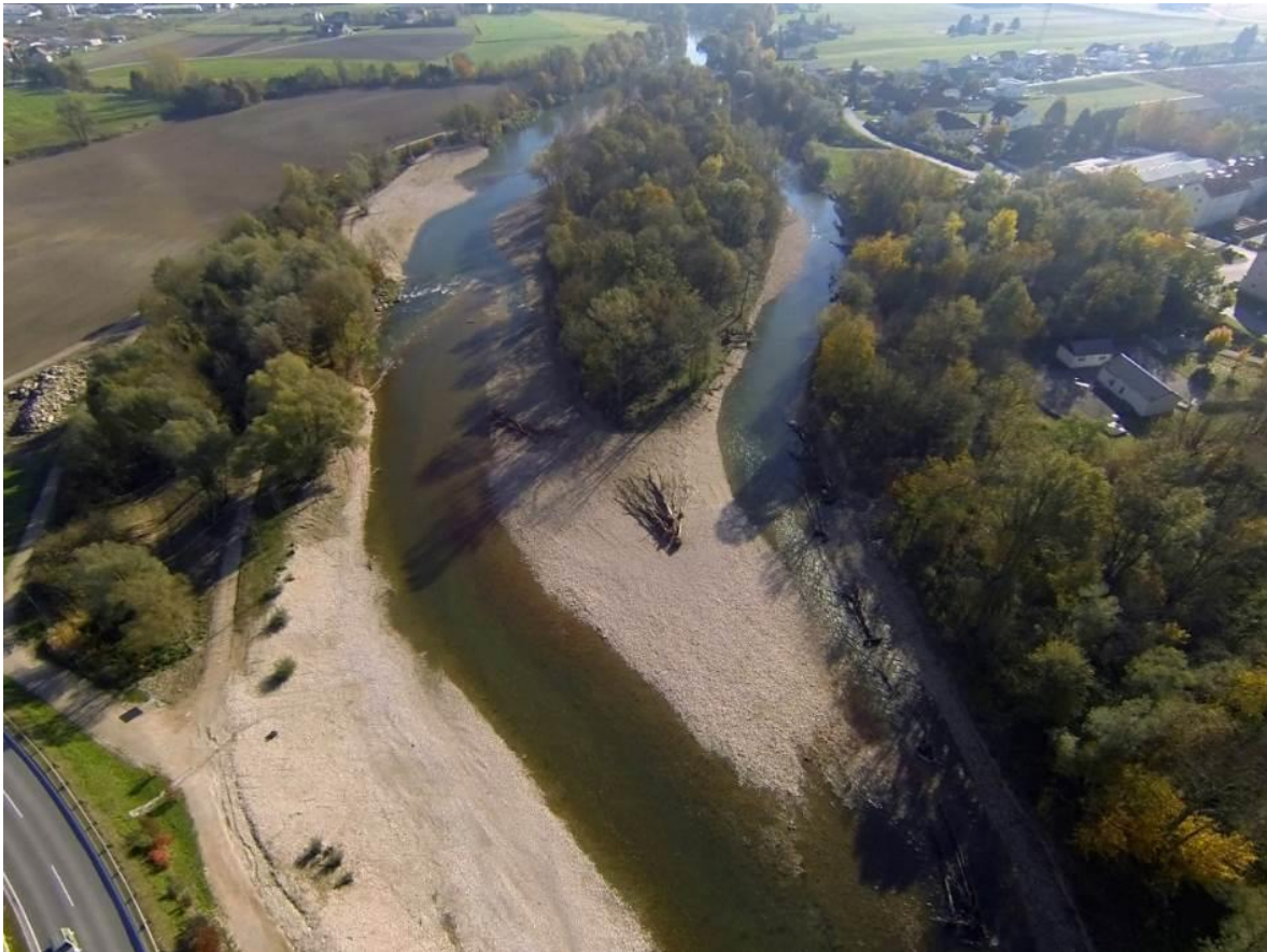
Abb. 113: Neu geschaffener Nebenarm (rechts) an der Ybbs (Niederösterreich). Angeströmte, ungesicherte Inselköpfe (vorne im Bild) weisen in der Regel einen besonders flachen Gradienten auf und stellen sowohl aquatische als auch terrestrische Habitate von hoher Wertigkeit dar. Bildquelle: M. Haslinger, www.extremfotos.com .
